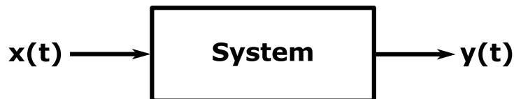
Abbildung 2.8: Schematische Darstellung eines Systems: Das Eingangssignal x(t) wird in das Ausgangssignal y(t) transformiert. Das System ist als „Blackbox“ dargestellt, dessen genauer innerer Aufbau nicht bekannt ist, wie z. B. bei den Delta-Netzteilen in Verbindung mit den Spulen.
