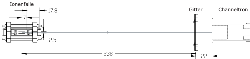
Abbildung 3.1: Maßstabsgetreue Skizze der Time-Of-Flight Strecke: Nach dem Abschalten der rechtsseitigen Endkappe der Ionenfalle wird das Ion in Richtung Channeltron beschleunigt. Nach etwa 400 ns hat das Ion die Endkappe erreicht und fliegt durch die 231 mm lange TOF-Strecke. Diese ist weitgehend feldfrei und das Ion wird dadurch kaum beschleunigt. Typische TOF-Zeiten sind je nach Ion in der Größenordnung von 10 \mu\text{s} . Alle Abmessungen in mm.
