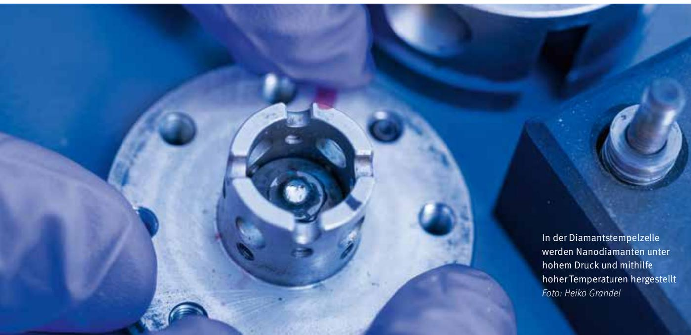
In der Diamantstempelzelle werden Nanodiamanten unter hohem Druck und mithilfe hoher Temperaturen hergestellt
