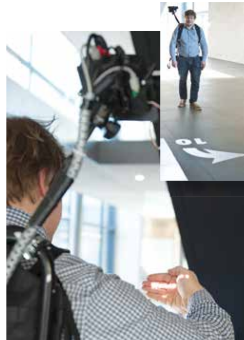
Foto: Christian Winkler, wissenschaftlicher Mitarbeiter am Ulmer Institut für Medieninformatik, hat eine neue Projektionstechnik entwickelt. Der Prototyp AMP-D kann bei der Orientierung in einer fremden Umgebung helfen. Private Informationen werden in die Handinnenfläche projiziert.
