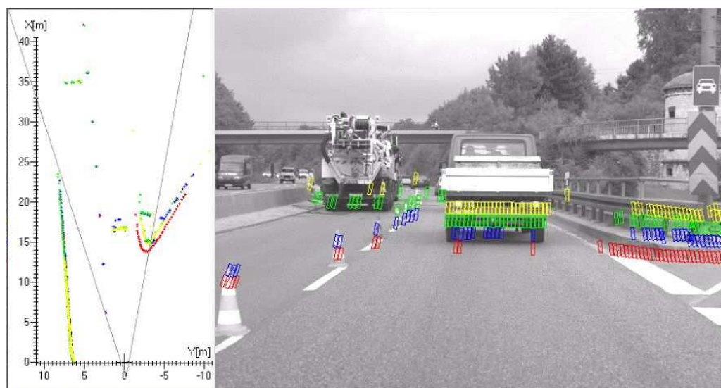
Abbildung 1: Links: Laserscannerdaten und Erfassungsbereich der Kamera. Rechts: Die Daten der vier Messebenen des Laserscanners in den Bildbereich projiziert.
