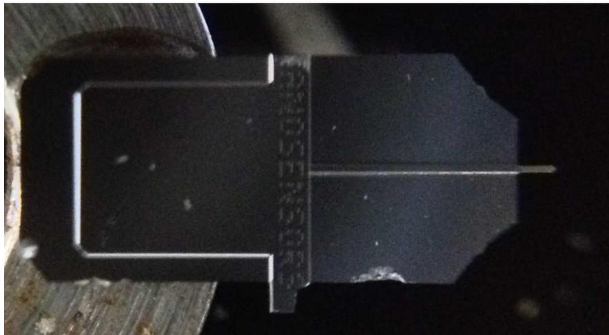
Abbildung 7.6.: Makrofotographie eines mikrotechnologisch hergestellten AFM-Cantilevers (Biegebalken)
