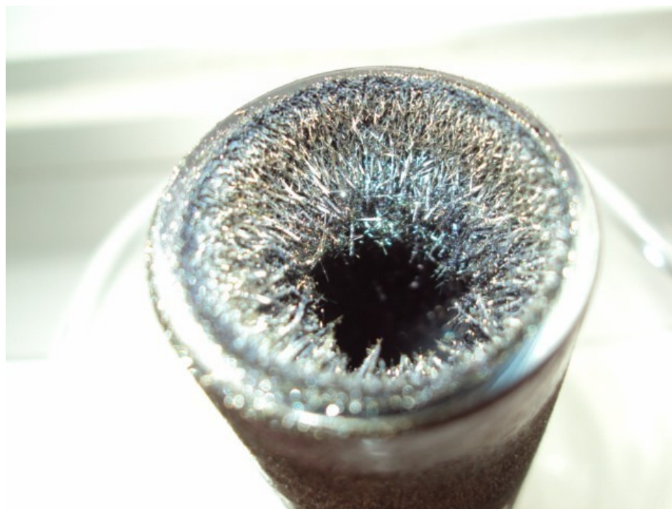
Abb. 2: Durch Sublimation gereinigtes Donormaterial hoher Kristallinität (DCV-Oligothiophen, Universität Ulm).
