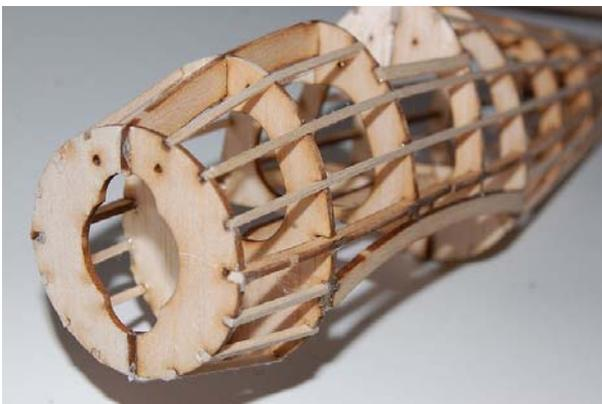
Abb.3 Modellflugzeugrumpf aus Balsaholz – Quelle:
