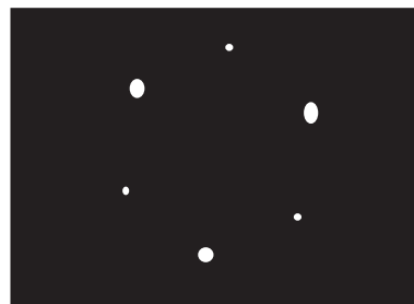
Abbildung 4.24.: Schematische Skizze eines LEED-Bildes von Ni(111) bei einer Primärenergie von 205\text{ eV} (gezeichnet nach [JSY82]).
