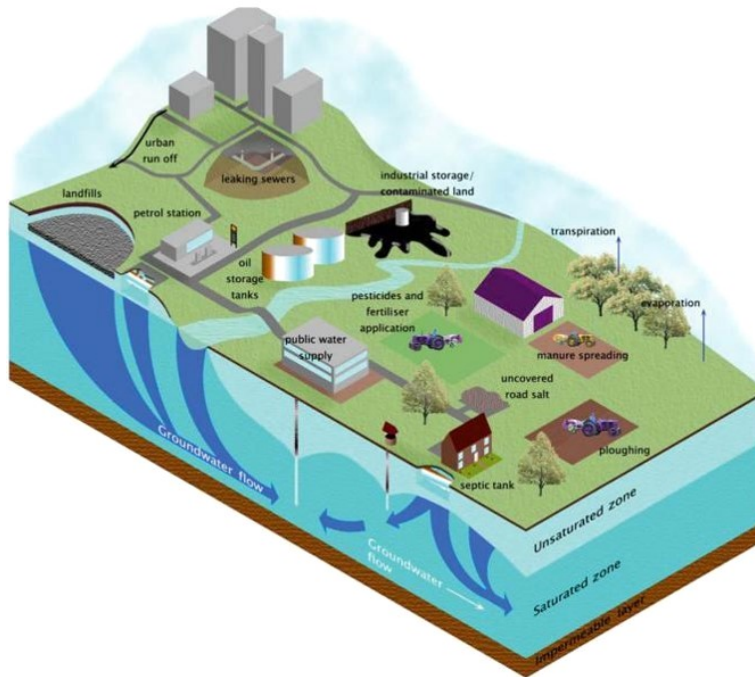
Abbildung 1.10: Grundwasser und unterschiedliche Verschmutzungswege (Quelle: UK Groundwater Forum, Public Domain)
