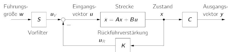
Abbildung 5.1: Zustandsregler (Mehrgrößenfall  $m, p \geq 1$ ).
