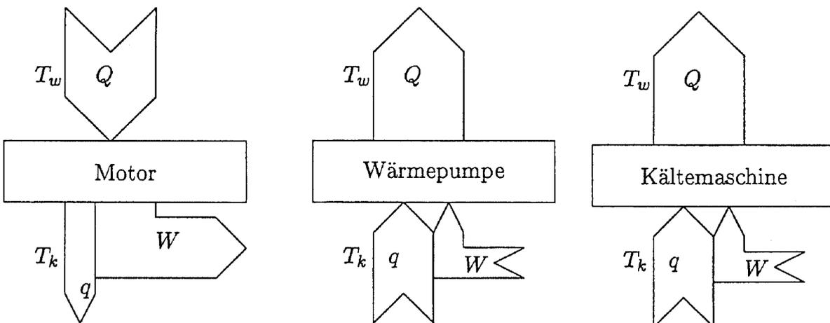
$$\begin{aligned} \eta_c &= \frac{\text{abgeg. Arbeit}}{\text{zugef. Wärme}} \\ \eta_c &= \frac{|W|}{Q} = \frac{Q - |q|}{Q} \\ &= 1 - \frac{T_k}{T_w} \end{aligned}$$
