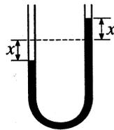
(Bild) Gießt man Flüssigkeit (Dichte  $\rho$ ) in ein U-Rohr, führt die Flüssigkeitssäule Schwingungen um die Gleichgewichtslage (Gleichstand der Flüssigkeitsoberfläche in beiden Schenkeln) aus, die infolge Reibung nach gewisser Zeit zum Stillstand kommen.
