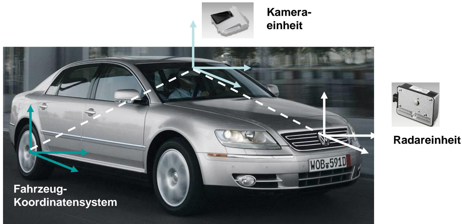
Beispiel: Sensorfusionssystem bestehend aus Kamera und Radar
