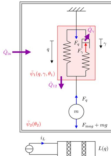
Abbildung 1: Schema des Modellproblems: Ein ferromagnetischer Körper, der über ein viskoelastisches Federelement aufgehängt ist, wird magnetisch aktuiert. Wärmeströme zwischen den thermischen Subsystemen und der Umgebung sind durch die violetten Pfeile angedeutet.
