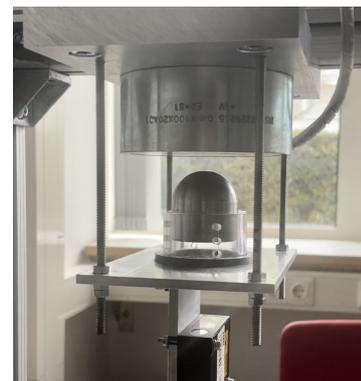
Abbildung 1: Schema und Foto des Versuchsaufbaus. Der Abstand wird durch einen Laser-Distanzsensoren gemessen und der Schwebekörper vertikal geführt, um Pendeln zu vermeiden. Im Experiment dient das Tastverhältnis  $d$  einer H-Brücke als Stellgröße.
