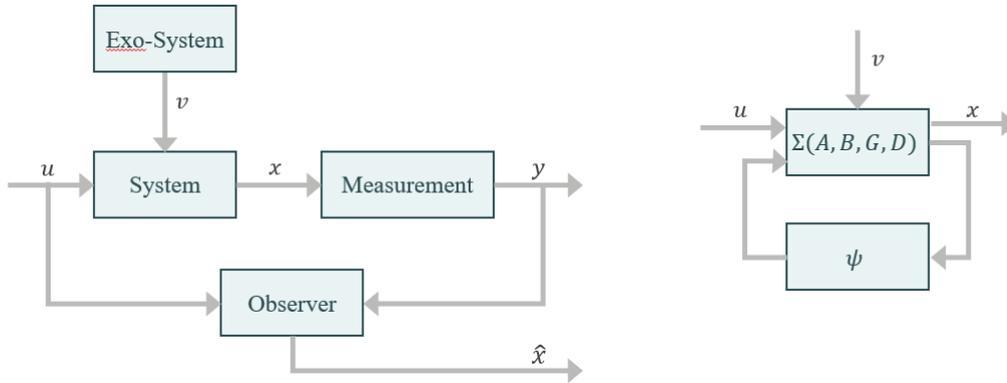
Abbildung 1: Links: Gesamtsystemstruktur, Rechts: Systemdynamik als Lur'e Verschaltung.
