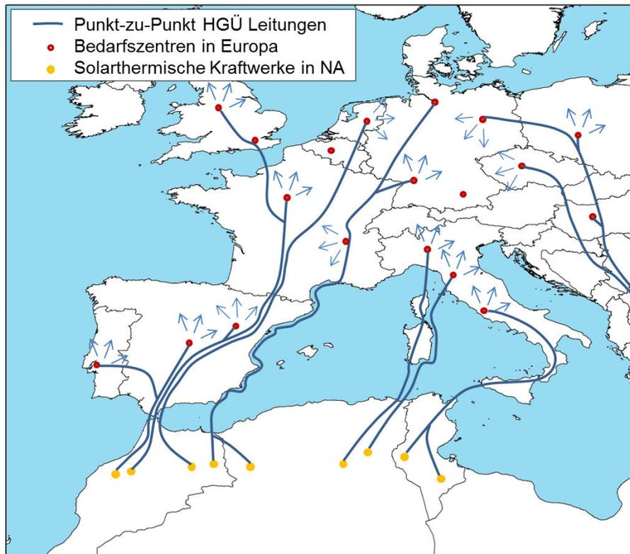
**Abbildung 1: Skizze von Punkt-zu-Punkt Hochspannungs-Gleichstrom-Übertragungsleitungen (HGÜ) die regelbaren Strom aus solarthermischen Kraftwerken in Nordafrika in die europäischen Ballungszentren bringen und dort ins konventionelle Stromnetz einspeisen, wo der Strom an die Verbraucher verteilt wird. Das konventionelle Stromnetz ist nicht dargestellt (BETTER 2014).**
