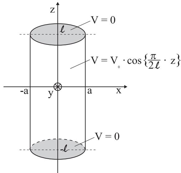
Abbildung 1: Zylinder mit geerdeten Deckeln und vorgegebenem Potential  $V$  auf dem Mantel.
