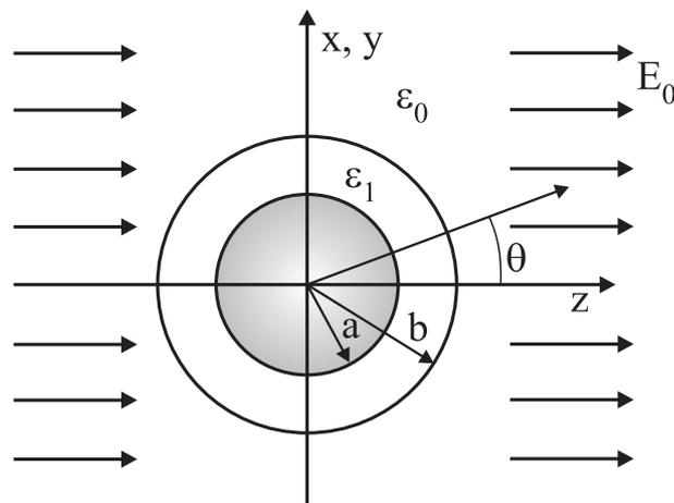
Abbildung 5.2: Dielektrische Hohlkugel um eine geerdete Metallkugel. Das skizzierte elektrische Feld soll von der Anordnung ungestört sein.
