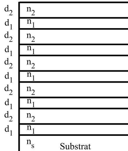
Abbildung 8.3: Schematischer Aufbau eines Braggreflektors. Die beteiligten Schichten haben immer eine optische Dicke von  $\lambda/4$  entsprechend der geometrischen Dicke  $\lambda/4n$ .
