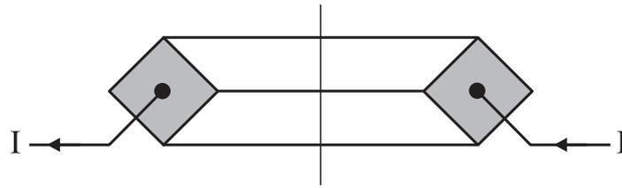
Abbildung 2.3: Leitfähiger Halbring mit Stromzuführung über die metallisierten Schnittflächen.
