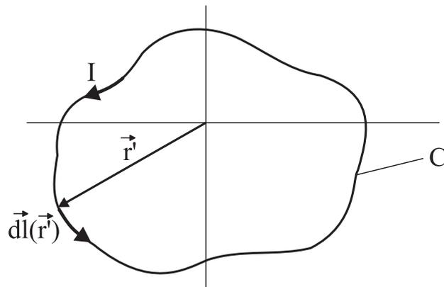
Abbildung 4.1: Geschlossener elektrischer Stromfaden, der von einem Strom der Stärke  $I$  durchflossen wird
