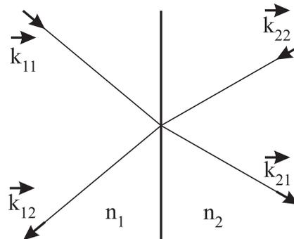
Abbildung 8.1: Überlagerung zweier gleich polarisierter Wellen von beiden Seiten einer Grenzfläche, so dass sich der jeweilige transmittierte Strahl der einen Welle und der reflektierte Strahl der anderen Welle gleich ausbreiten.
