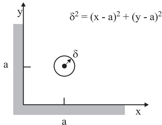
Abbildung 5.3: Leitfähige Platte im ersten Quadranten mit zylindrischer Stromzuführung im Punkt  $x = a, y = a$
