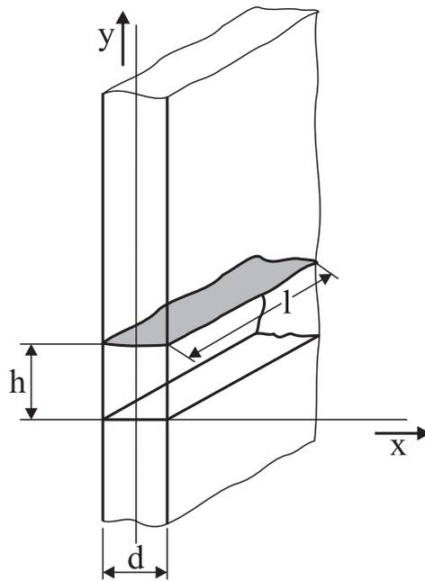
Abbildung 9.1: Transformatorblech im homogenen Magnetfeld.
