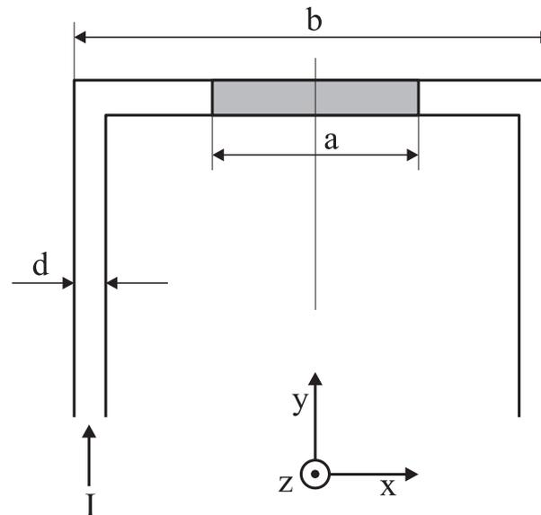
Abbildung 3.3: Anordnung einer unendlich ausgedehnten Leiterschleife. Die Kraft auf das schraffierte Leiterstück ist unter der Voraussetzung  $d \ll b$  gesucht.
