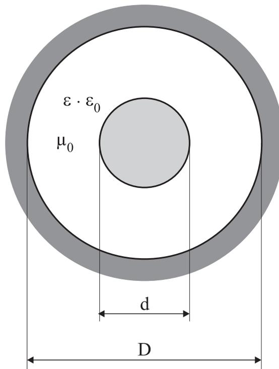
Abbildung 10.1: Querschnitt durch ein Koaxialkabel.
