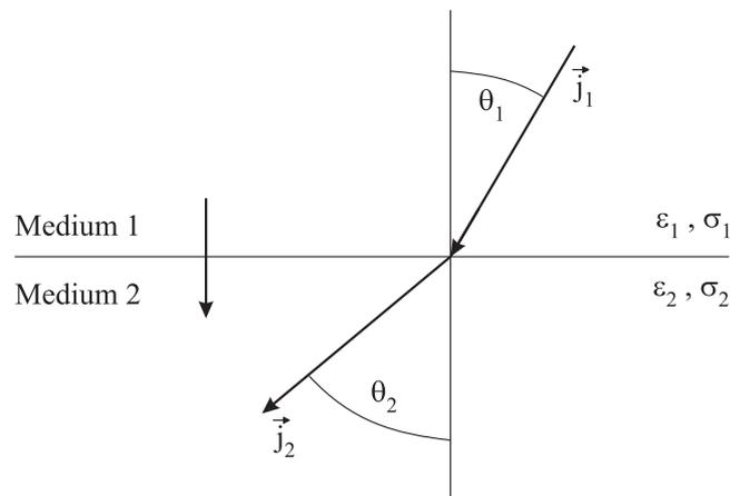
Abbildung 2.1: Stromfluss über eine Grenzfläche zweier Medien
