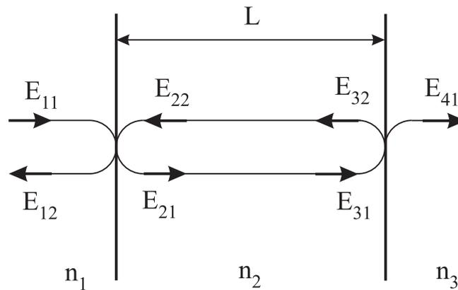
Abbildung 8.2: Fabry Perot Etalon. Die hin- und rücklaufenden Wellen an den jeweiligen Grenzflächen sind durch Pfeile angedeutet.
