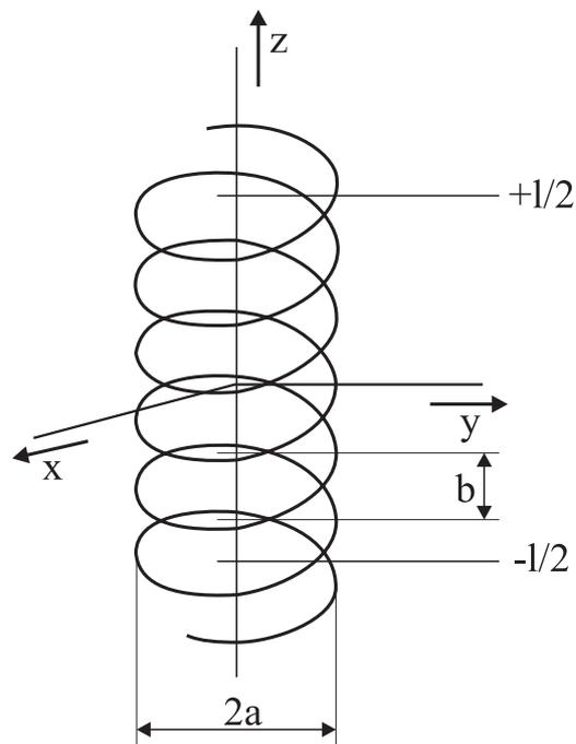
Abbildung 3.1: Zylindrische Spule mit dünner Wicklung und kreisförmigen Querschnitt
