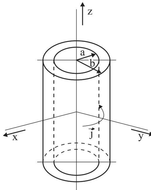
Abbildung 3.2: Modell einer zylindrischen Spule mit dickem Wicklungspaket und kreisförmigem Querschnitt.
