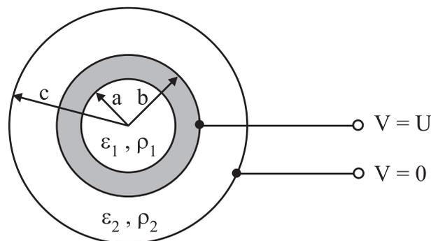
Abbildung 2.4: Querschnitt durch die Leiteranordnung. Die Zylinderachse verläuft senkrecht zur Zeichenebene.
