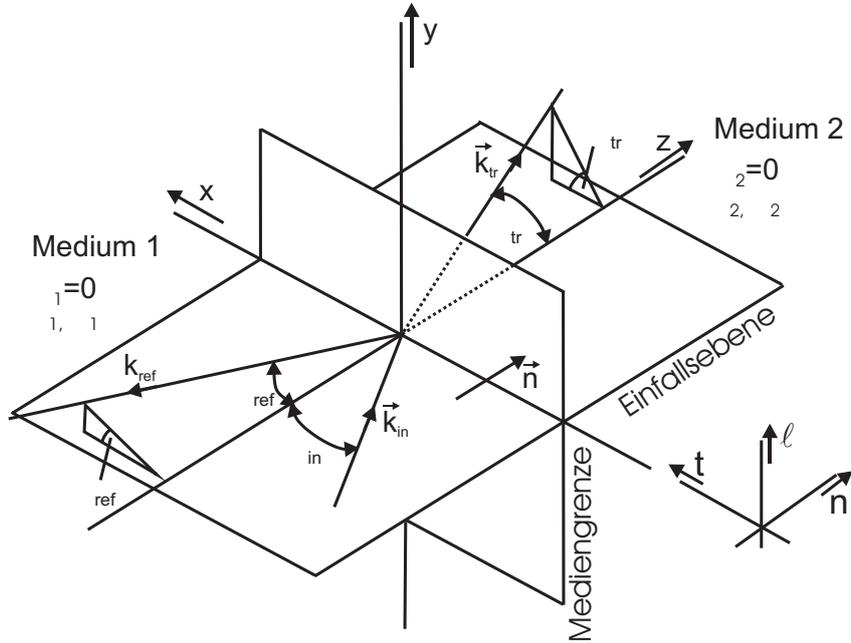
Fällt eine ebene Welle auf eine Grenzfläche, so wird sie dort teilweise reflektiert und teilweise gebrochen.
