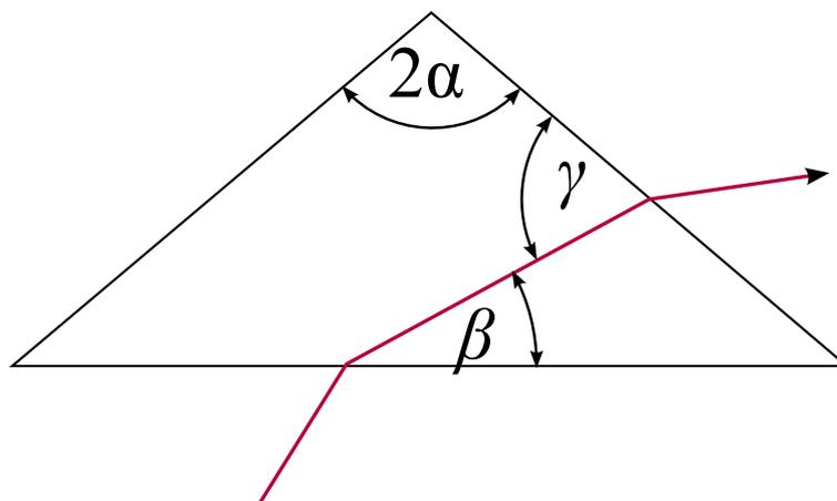
Abbildung 1: Pyramidenförmige Oberfläche einer Leuchtdiode. Das Licht tritt unter dem Winkel  $\beta$  an der Basis in die Pyramide ein und soll die Seitenfläche ohne Totalreflexion passieren.
