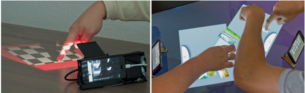
Abb. 4 Das „SurfacePhone“ projiziert über einen ausklappbaren Spiegel ein verhältnismäßig großes Display direkt hinter das Smartphone. Es unterstützt Touch-Interaktion, indem Finger-Positionen von der eingebauten Smartphone-Kamera und Finger-Touches (leicht und stark) vom eingebauten Beschleunigungssensor erfasst und korreliert werden (links). Ferner werden Gesten und das automatische Vereinen von Projektionen mehrerer Geräte zum Austausch von Inhalten wie z. B. Bildern (rechts) unterstützt
