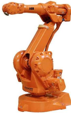
Abbildung 1.6: ABB Industrieroboter.
