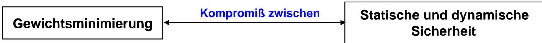
**Gewichtsminimierung** mit der Forderung nach Steifigkeit hinsichtlich **Stabilität** und **Schwingverhalten** und der Frage nach **Betriebsfestigkeit**.
