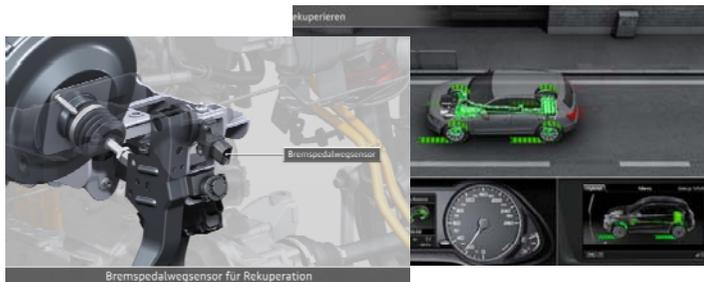
Beispiel : elektrisches + mechanisch/hydraulisches Bremsen im Hybrid
