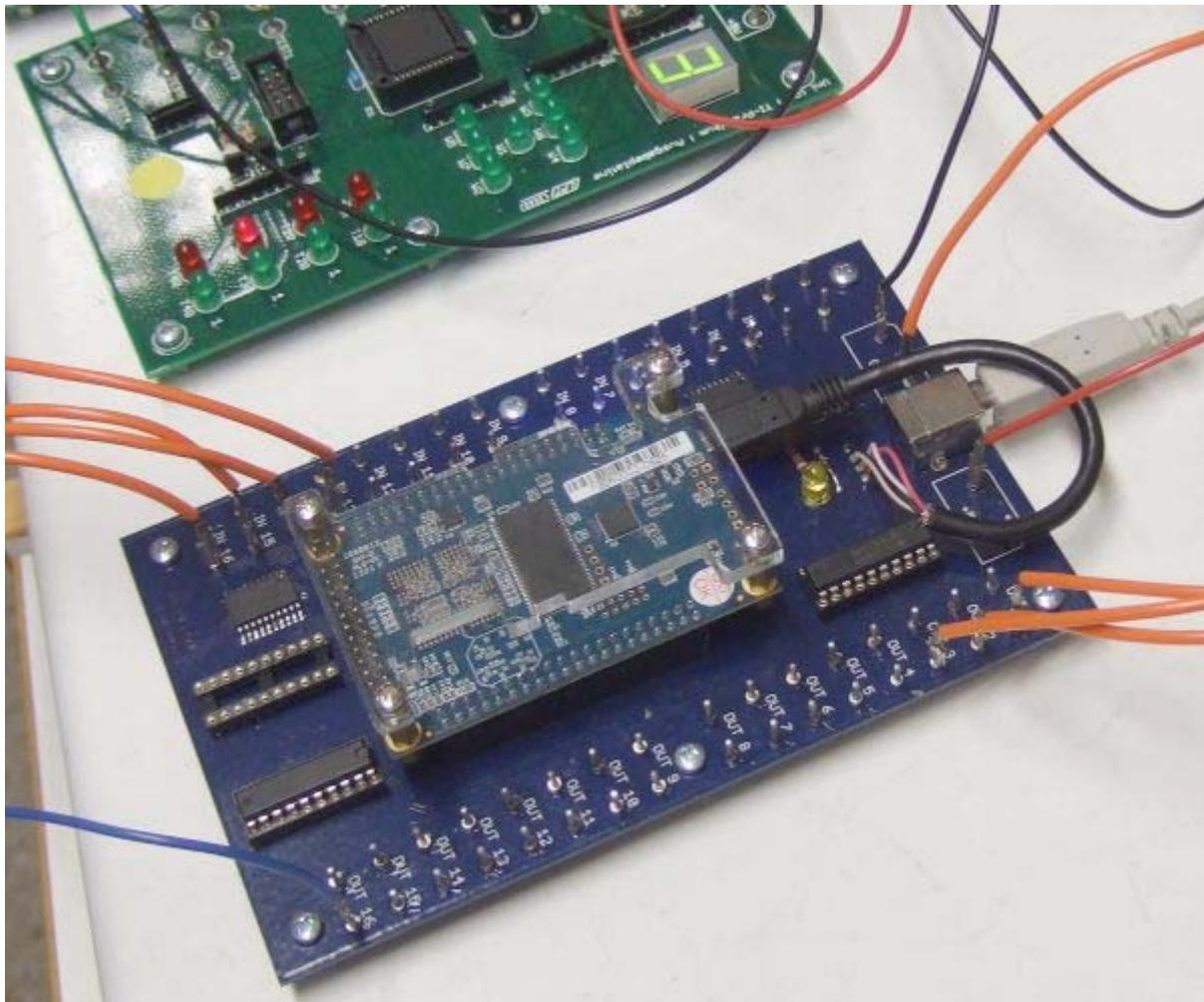
Am oberen Rand befindet sich der USB-Anschluss zum Programmieren des FPGAs. Hier muss ein USB-Kabel zum Entwicklungsrechner angeschlossen werden. Daneben sind die üblichen 5 Volt und GND Anschlüsse. Ansonsten sind 16 Eingänge IN1 bis IN16 und 16 Ausgänge OUT1 bis OUT16 vorhanden, wie immer im Praktikum mit je zwei Steckstiften.
