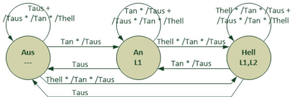
Die Prüfung für den Zustand "Aus": wird immer genau ein Pfeil (Zustandsübergang) gefunden:
