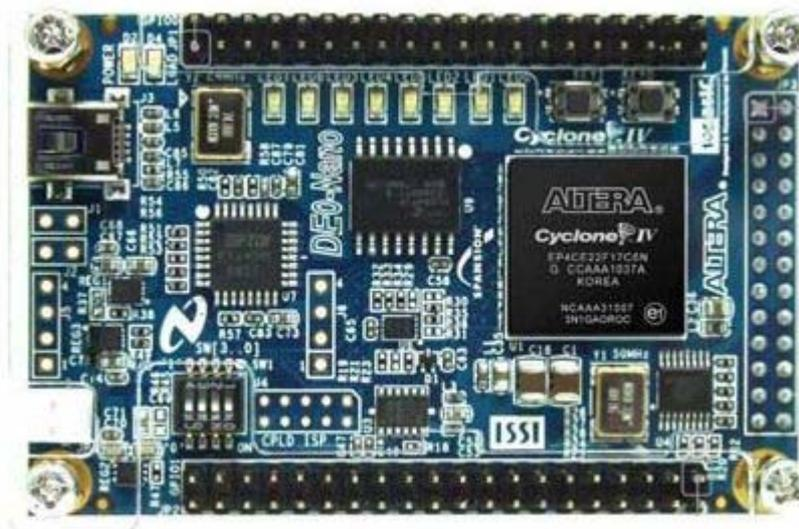
FPGAs sind ICs, die konfiguriert werden können. Typisch kümmert man sich nicht um die Details der Chips, sondern überläßt der Software die Aufgabe VHDL auf den Chip abzubilden. Trotzdem sollte man wissen, wie ein solches FPGA intern aufgebaut ist, schon um abschätzen zu können, was machbar ist.
