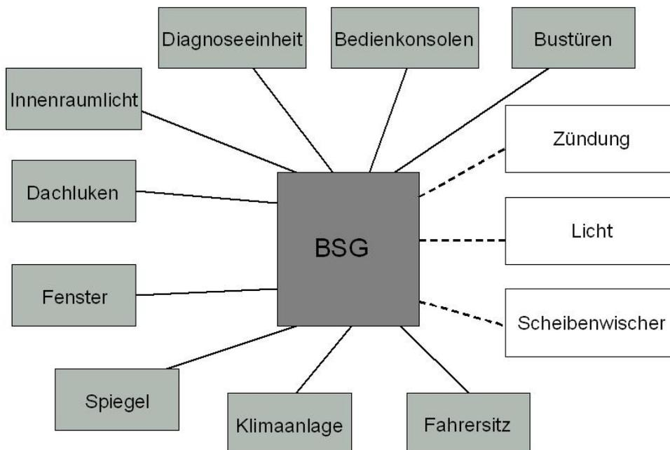
Abbildung 1.1: Schematische Übersicht über das BSG
