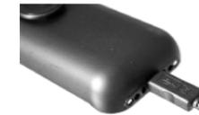
USB-Kabel an den USB-Anschluss des Telefons anschließen. Das andere Ende des USB-Kabels am Netzteil oder einem USB-Anschluss anschließen.
