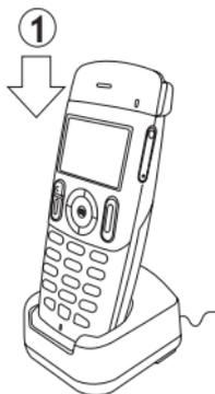
Ladegerät an das Netz anschliessen und DECT-Handset in die Ladestation einlegen. Die Telefon-LED-Anzeige leuchtet grün beim Laden.
