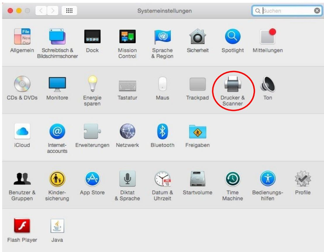
3. Über das (+)-Symbol wird ein neuer Drucker hinzugefügt:
