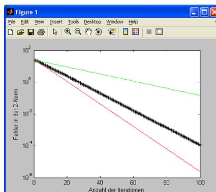
Das Programm berechnet zur rechten Seite  $b=1$  und einer gegebenen Matrix  $A$  die Lösung  $x$  zu  $Ax=b$  mittels Gauß-Seidel-Verfahren. (Richardson- und Jacobi-Verfahren sind ausdokumentiert.) Des Weiteren wird der Fehler zur exakten Lösung bestimmt und in Abhängigkeit von der Iterationszahl graphisch dargestellt.
