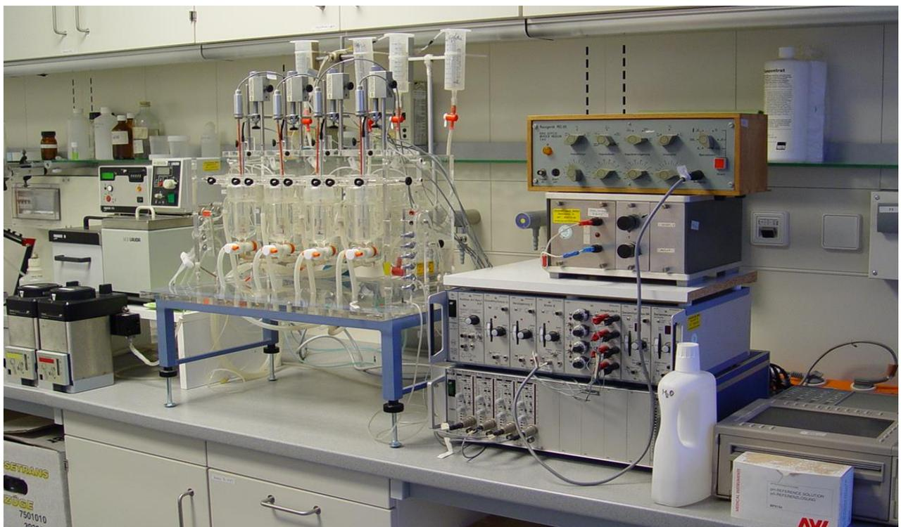
**Abbildung 2:** In vitro Kontraktur Testanlage. Im physiologischen Organbad werden die Muskelproben verschiedenen Triggersubstanzen ausgesetzt. Eine abnorme Reaktion (Kontraktur) zeigt die Anlage zur MH sicher an bzw. schließt sie aus.
