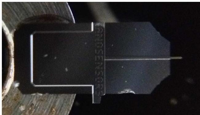
Abb. 4.6.: Mikrofotografie eines Cantilevers.
