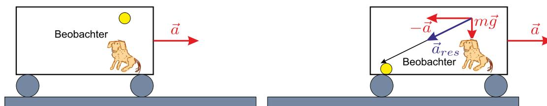
Abb. 3.15.: Standpunkt eines **mitbewegten** Beobachters: Fall in einem beschleunigten Wagen.
