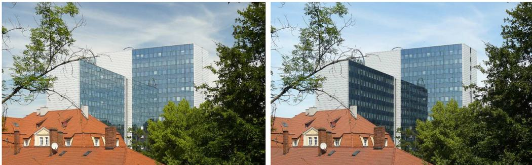
Abbildung 6.15.: Das gleiche Gebäude mit Polarisationsfilter aufgenommen. Die Achse des Polarisationsfilters wurde dabei um  $90^\circ$  gedreht. Links sind die Reflexionen im Glas kaum zu erkennen, rechts ist dafür der Kontrast des Himmels schwächer.
