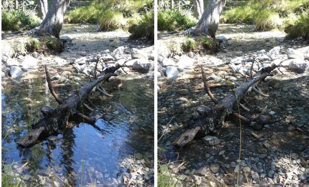
**Abb. 6.21.:** Polarisation bei der Spiegelung an Wasser. Links ist der Analysator so gestellt, dass das an der Wasseroberfläche reflektierte Licht durchgelassen wird. Rechts die gleiche Szene, aber der Analysator blockt das an der Wasserfläche reflektierte Licht.
