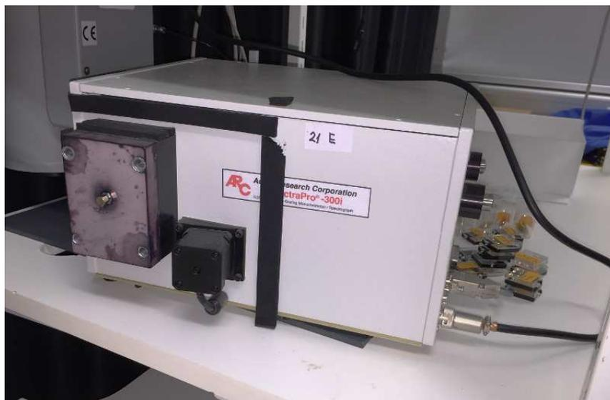
Abbildung 6.28.: Ein kommerzielles Gitterspektrometer, wie es im Labor des Instituts für Experimentelle Physik an der Universität Ulm verwendet wird.
