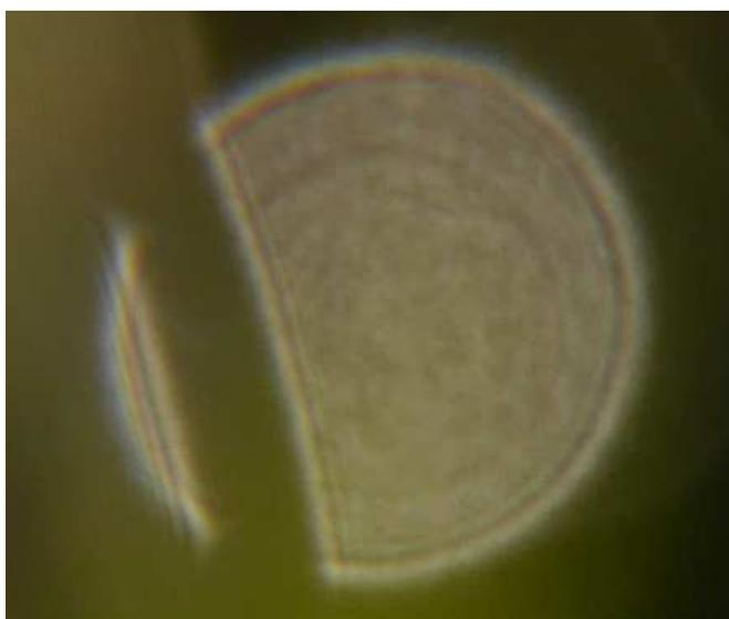
Abbildung 3.37.: Weisslichtinterferenz an der Blende eines Objektivs. Abgebildet ist ein defokussierter Wassertropfen.
