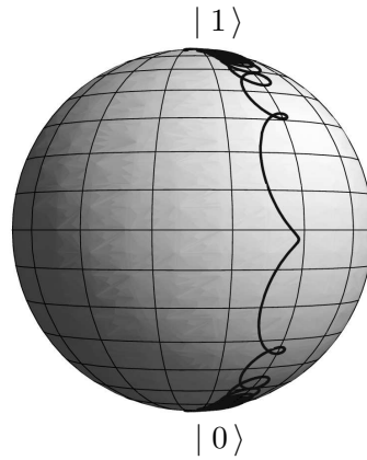
Abbildung 5.7: Spur des Blochvektors bei einem Populationstransfer von |0\rangle nach |1\rangle mit einem RAP-Puls.
