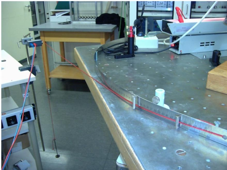
Abbildung 4.5: Messung der Drehgeschwindigkeit mittels eines Tachogenerators
