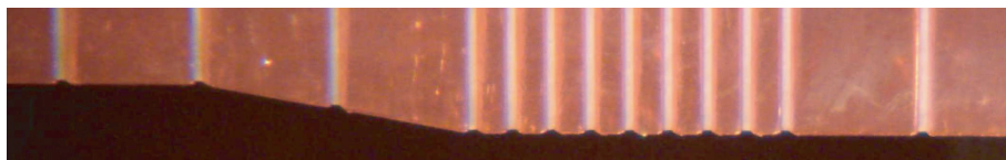
Abbildung 3.16: Detailansicht der PCB-Falle. Der Experimentierbereich wird von acht Elektroden mit einer Breite von 500 \mu\text{m} gebildet. Zwischen den Elektroden befinden sich 120 \mu\text{m} breite Isolierungen.
