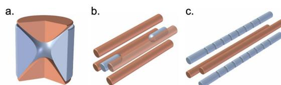
Abb. 1: Evolution der Paulfallen: Paulfalle mit hyperbolischen Elektroden (a), lineare Paulfalle mit Endkappen (b) und lineare Paulfalle mit segmentierten Elektroden (c) bestehend aus Gleich- (blau) und Wechselfeldselektroden (braun).
