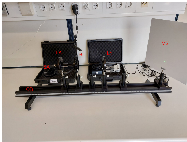
Abbildung 2: Blick auf den Versuchsaufbau mit einigen Komponenten: Laser LA, Blende BL, Linse L1, Mattscheibe MS, optischer Bank OB und einstellbarer Spalt SA. Hinter der Linse liegt die Zeilenkamera.
