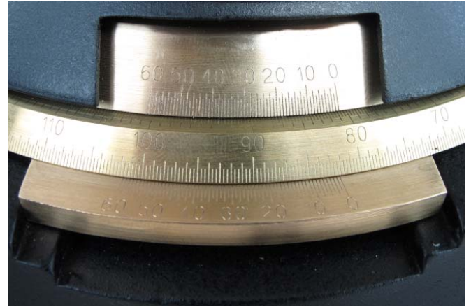
Abb. 3: Foto der Winkelskalen: obere Skala: Position des Tisches, mittlere Skala: fest verbunden mit dem Kollimator, untere Skala: fest verbunden mit dem Okularfernrohr
