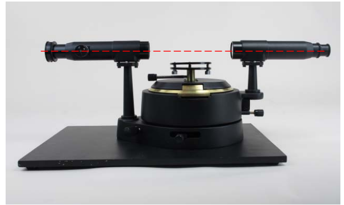
Abb. 10: Fernrohrjustierung in einer Linie
