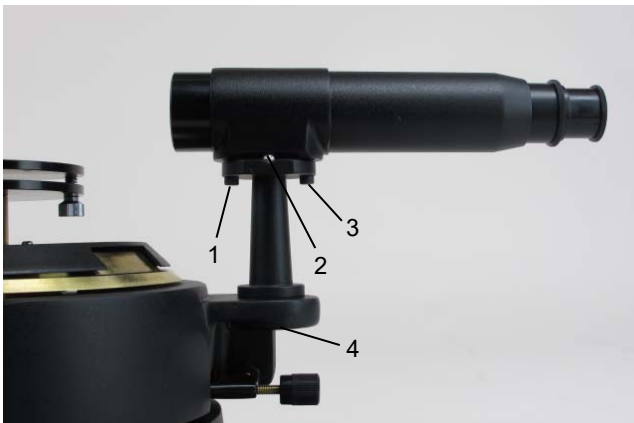
Abb. 9: Verstellen der grundlegenden Fernrohrjustierung
