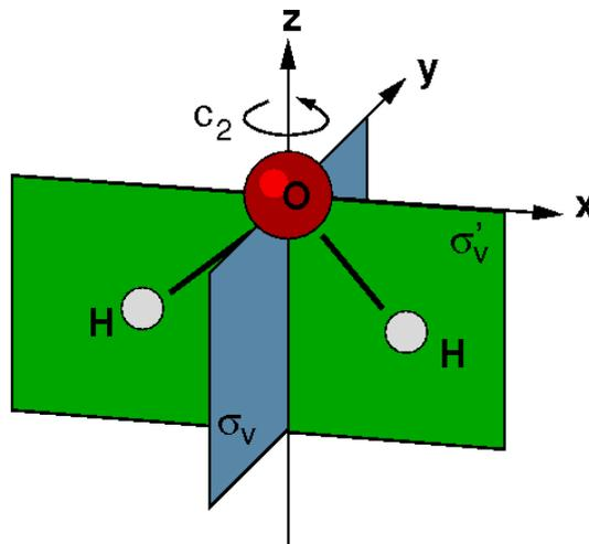
Abbildung 1: Das  $H_2O$  Molekül und seine Symmetrieoperationen.
