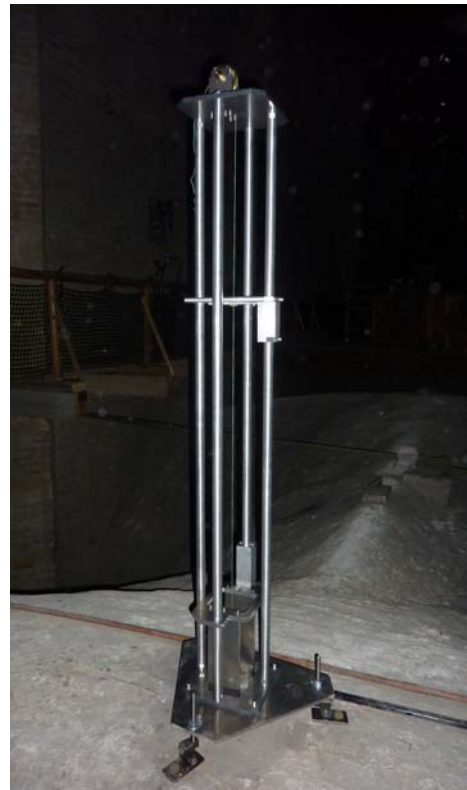
BILD 4: DIE PENDELAUFHÄNGUNG IST IM NÖRDLICHEN SEITENSCHIFF ÜBER DER MITTELÖFFNUNG DES GEWÖLBES BEFESTIGT.
