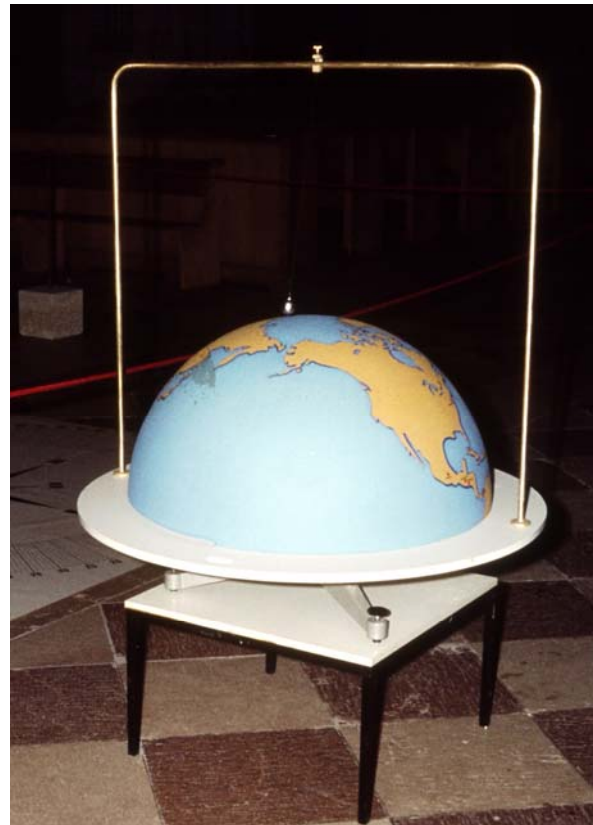
BILD 6: MODELL, DAS BEI DER PENDELAUFHÄNGUNG 1979 VERWENDET WURDE. IN VERLÄNGERUNG DER DREHACHSE IST EIN FADENPENDEL BEFESTIGT.
