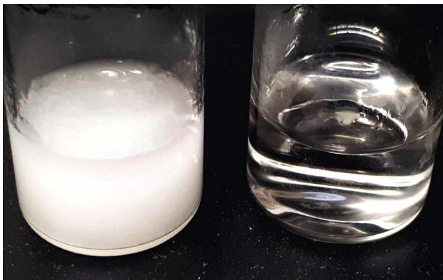
Links im Bild ein Behälter mit Wasser, das mit Mikroplastik-Partikeln verschmutzt ist, rechts das „saubere“ Wasser, das mithilfe magnetischer Nanopartikel gereinigt wurde
