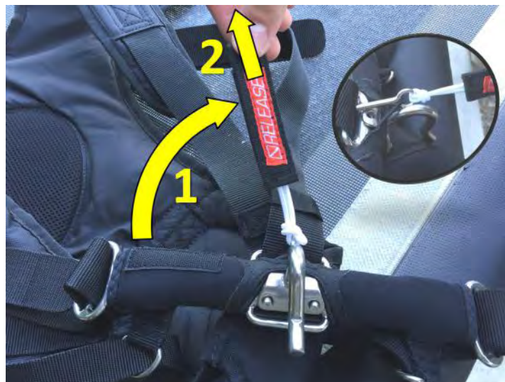
Seitenansicht des Trapezmechanismus'. Hier sieht man alle Elemente: Haken mit Grundplatte, Sicherungsstift und "Release".
