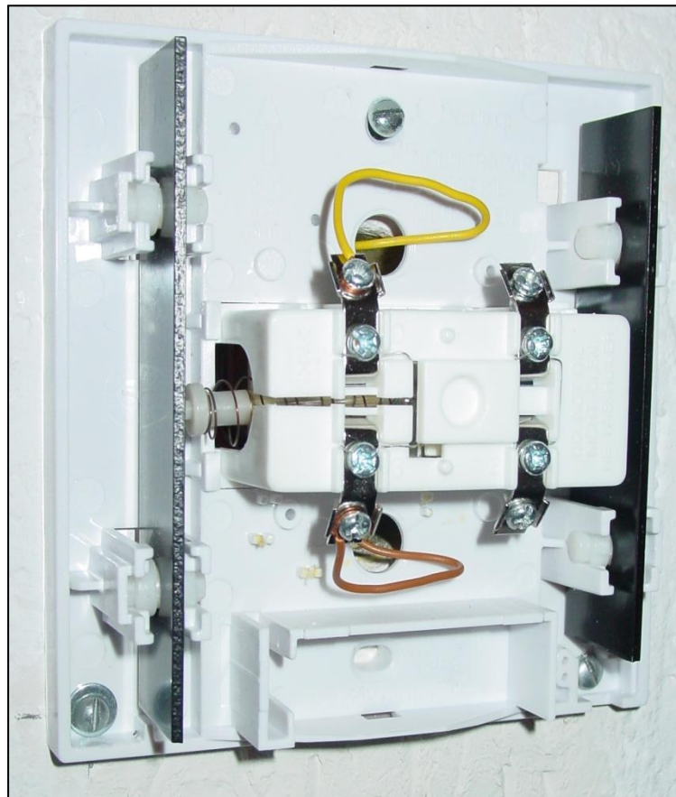
Bild 1: Türgong mit zwei Gong-Klangplatten (links und rechts: „Ding-Dong“) und einem elektromagnetisch angetriebenen Stößel in der Mitte.
