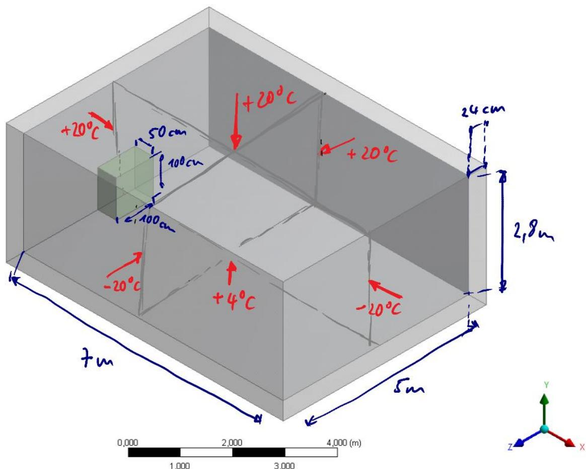
Der Raum besitzt zwei Außenwände, drei Innenwände, einen Fußboden und keine Fenster. Das Ziegelmauerwerk ist nicht isoliert (oder verputzt). Der Wärmetransport soll zunächst nur mittels Konvektion und Wärmeleitung stattfinden. Der Ofen soll aus (schwarzem) Gußeisen bestehen und eine Heizleistung von 8 kW aufweisen.
