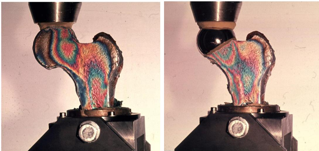
Abb. 13: Isochromatenbilder des Oberflächenschichtverfahrens an einem belasteten Hüftkopf mit und ohne künstlichem Gelenkersatz.
