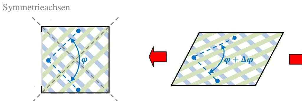
Die grünen Fasern sind nachgiebiger und dehnen sich daher im oberen Beispiel mit Belastung in Faserrichtung stärker als die grauen. Im zweiten Beispiel mit geändertem Belastungswinkel ist die Dehnung in Zugrichtung weniger stark ausgeprägt, da nun die steiferen blauen Fasern den Werkstoff in Zugrichtung verstärken.
