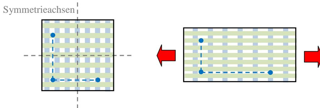
Dehnungen und Scherdehnungen auf. D.h. belastet man einen rechteckigen orthotropen Werkstoff (z.B. ein Gewebe) in den Symmetrieebenen, so tritt keine Dehnungs-Schiebungskopplung auf. Er bleibt rechteckig.
